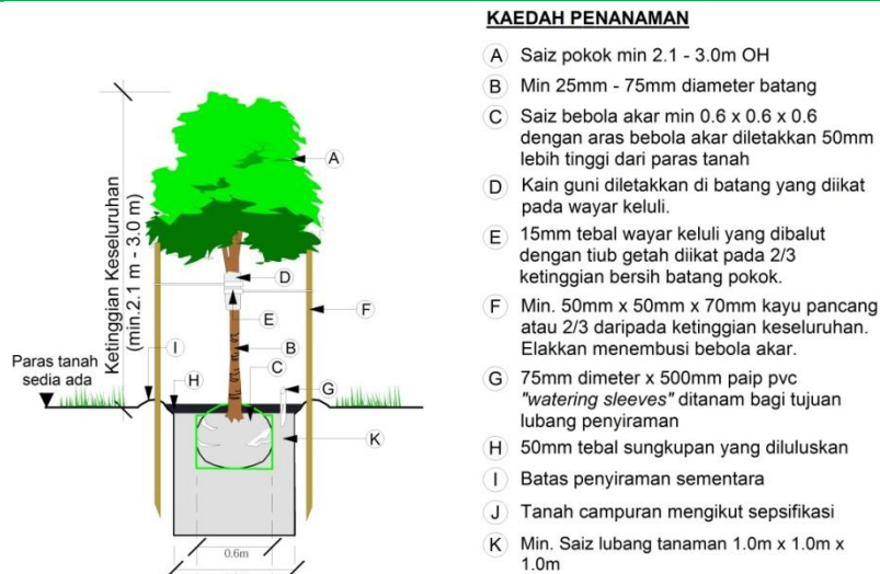
Gambar rajah 14: Cara penyediaan lubang tanaman bagi pokok teduhan
